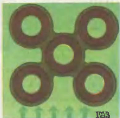
Пленочный режим движения жидкости в колонне с насадкой.
